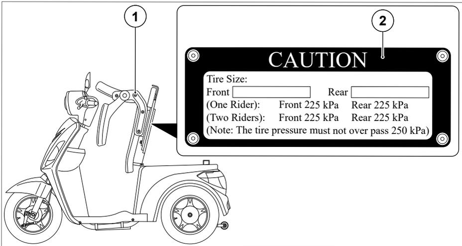
Abb. 12 Reifenluftdruck - Hinweisschild
