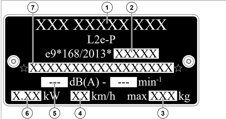
Abb. 1 Typenschild (Beispieldarstellung)
