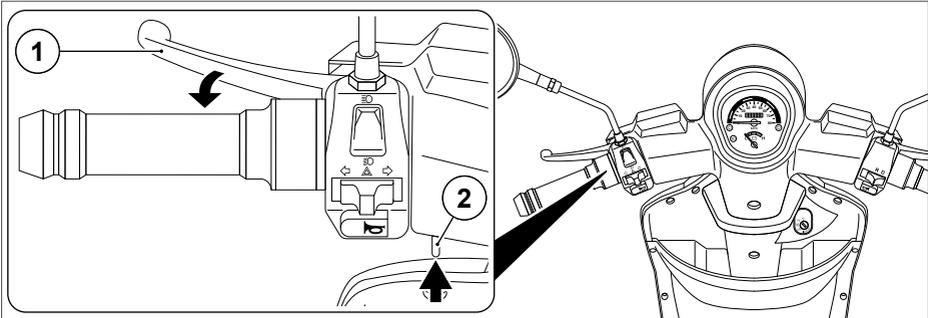
Abb. 10 Feststellbremse
